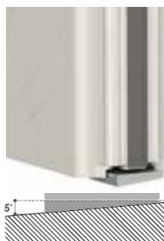
Sous rail incliné
