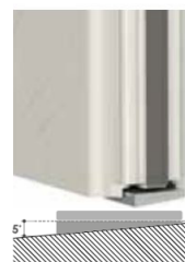
Sous rail incliné
